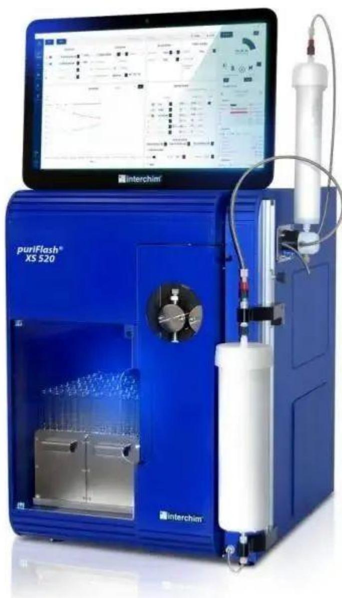
实用高效的 puriFlash® XS 520 Plus 色谱系统，具有 300mL/min 和 20bar 的性能，占用空间小，可以使用内径高达 80mm 的全系列制备柱 4g 到 800g 色谱柱。由 InterSoft X 智能软件控制，将轻松设置和优化工作过程中涉及的所有参数，获得优秀的分离效果、纯度和收率。
