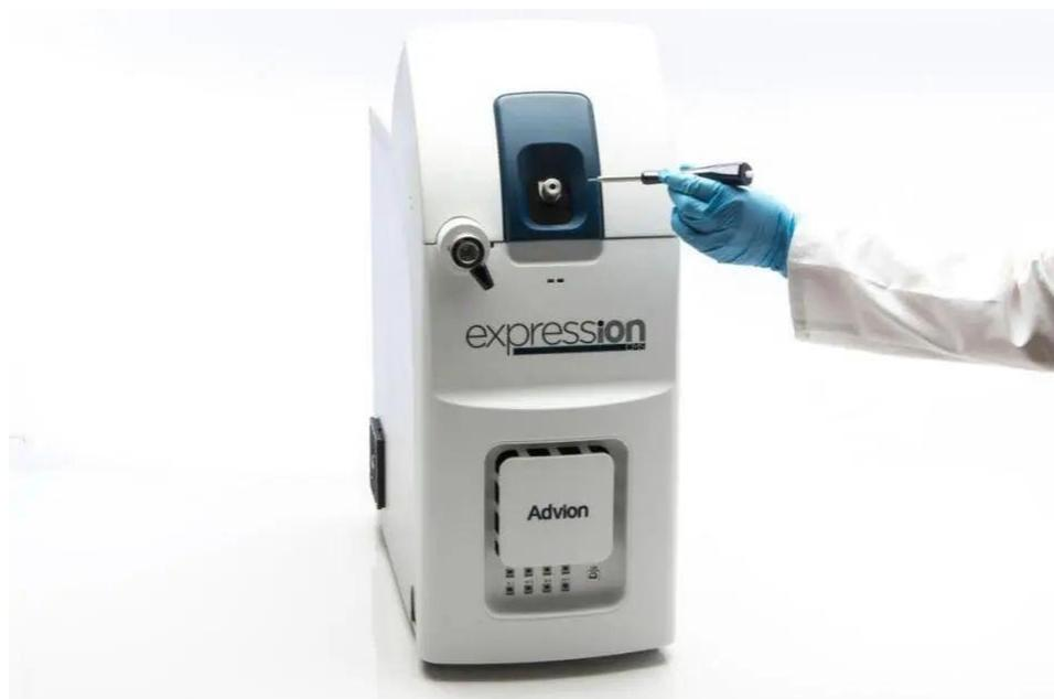
ASAP 为化学工作者提供了快速可靠的固液体样品分析手段，包括纯化制备馏分收集液、有机合成反应液、食品环境样品、天然产物等。ASAP 无需样品前处理及色谱分离，可在 30 秒内给出检测数据，可实时监测反应进展。
