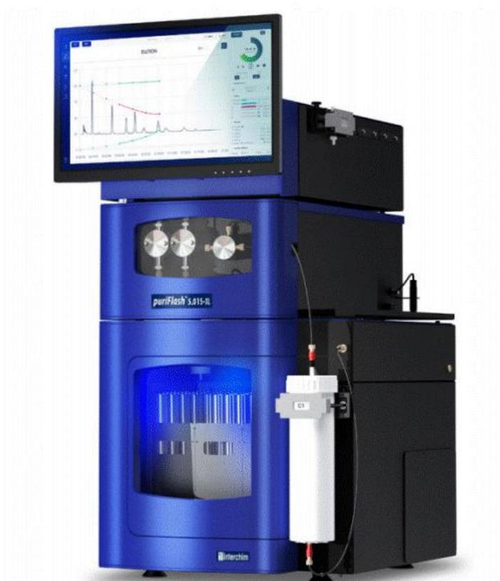
puriFlash®5.015-XL 凭借双柱泵的稳定性能，实现其 825mL/min 分钟的流速，保证产能高达数公斤。该系统兼具可靠性和耐用性，显著提升上样量，加持系统安全的特性，可半连续生产达到公斤的化合物，实现在同一设备上连续独立的放大生产。系统兼容所有的 Flash 柱，并可使用 F1600 色谱柱，内径高达 150mm。由 InterSoft X 智能软件控制，将轻松设置和优化工作过程中涉及的所有参数，获得完美的分离效果、纯度和收率。
