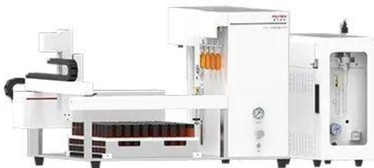
8100 水/土一体进样器可自动处理 40mL 小瓶中的样品，用于挥发性有机物 (VOC) 的吹扫捕集分析。高效处理多达 100 个饮用水、废水、或土壤样品，可与吹扫捕集联用。8100 水/土一体进样器采用新技术，提高了样品处理的可靠性，降低了样品分析的难度。采用机械抓手能有效的避免样品的掉落。土样进样针和水样进样针独立，两个样品流路有效避免了水样品和土样品交叉污染的可能。独立的水取样台和土取样台。配备质量流量控制器 MFC，当吹扫固体样品时，以提供精确控制的气流。吹扫气路和系统气路独立控制。
