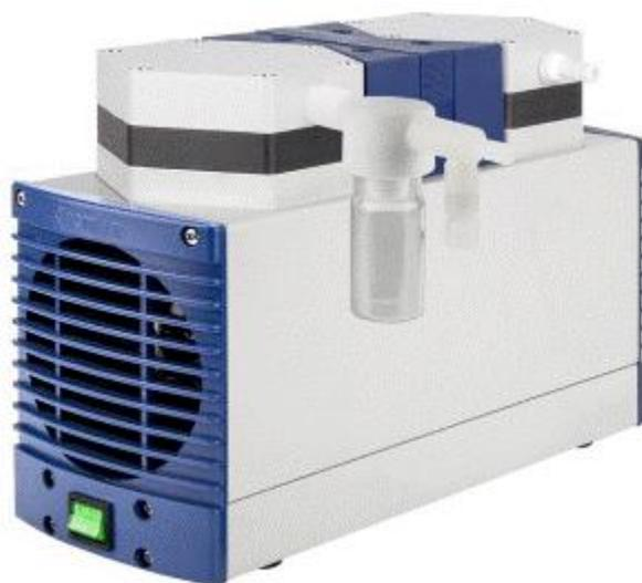
WIGGENS 防腐蚀隔膜真空泵适合于化学、制药、石化等行业对腐蚀性气体的处理, 如抽滤, 减压蒸馏, 旋转蒸发, 真空浓缩, 离心浓缩, 固相萃取等使用。WIGGENS 的防腐蚀隔膜泵具有优异的耐化学腐蚀设计, 与气体接触部分, 均为聚四氟乙烯 (PTFE) 材料, 不仅进气口到出气口的化学腐蚀性气体有很好的耐受性, 而且对冷凝液有很好的耐受性。抽气腔和驱动部件所在的腔室是密封分离的, 确保机械部件的使用寿命。另外隔膜泵是无油泵, 和油泵相比减少了大量的维护工作, 相对水喷抽气泵, 隔膜泵节省了大量水资源, 而相对旋片泵, 它不会产生污染的废弃泵油。
