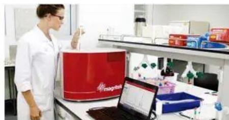
Spinsolve™ 台式微型核磁共振波谱仪是新西兰 Magritek 公司研发生产的永磁体核磁共振仪器。由于该仪器具有超强的稳定性，使其可以安装在普通实验室。让用户在本实验室内即可迅速测试自己的样品，一般 7 秒或一分钟内即可获得有效的谱图。
