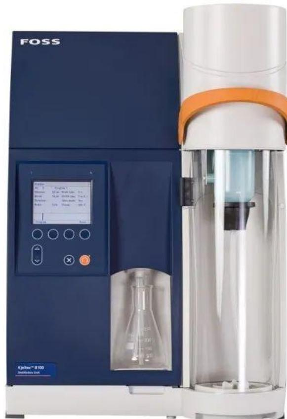
Kjeltec™ 8100 是一款半自动蒸馏装置，主要用于凯氏定氮分析，但也广泛用于各种不同的蒸馏方法。这是一种简单而通用的解决方案，可用它预先设定碱和稀释液添加、蒸馏和试管排出。该解决方案特别适合日常样品量较少的实验室。
