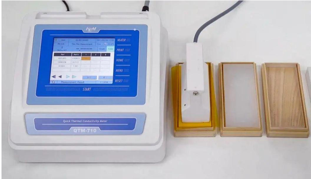
1. 采用 5.7 英寸彩色触控屏，显示直观且操作方便。
