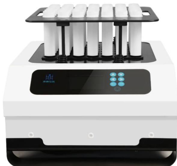
智能石墨消解仪除了可完成热消解和赶酸步骤外，还配置了样品混匀和托举冷却功能，初步实现了无机样品前处理步骤的集成处理。样品架可全角度回旋震荡，仿真“手动摇瓶”，完成样品混匀；样品架可托举升起至消解管完全脱离石墨体，提高冷却效率。
