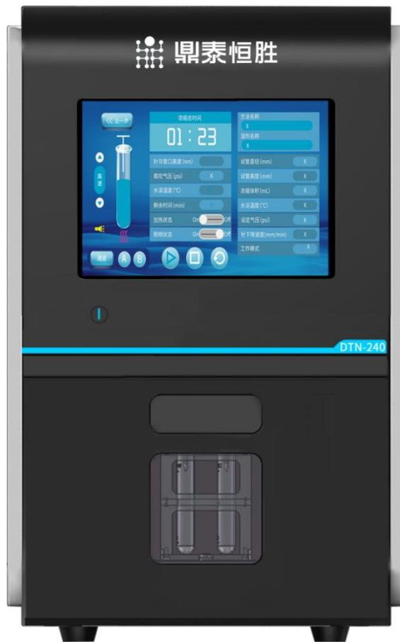
利用水浴加热和氮吹的共同作用对样品进行浓缩，可同时处理 24 个样品。运行过程中可通过操作屏幕实时监控浓缩状态。氮吹针可随液面自动下降，提高浓缩效率；浓缩结束后，氮吹针自动升起，精准高效。
