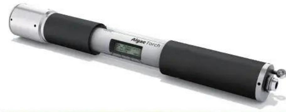
便携式藻类分析仪是一款能够对蓝绿藻浓度及叶绿素 a 总量进行定量分析的检测设备，该设备具有轻便、易携带、分析快速、操作方便、测量准确度高等特点。不需要任何样品准备过程，只需打开设备电源开关并将设备浸入水中，20 秒后即可得到检测结果。
