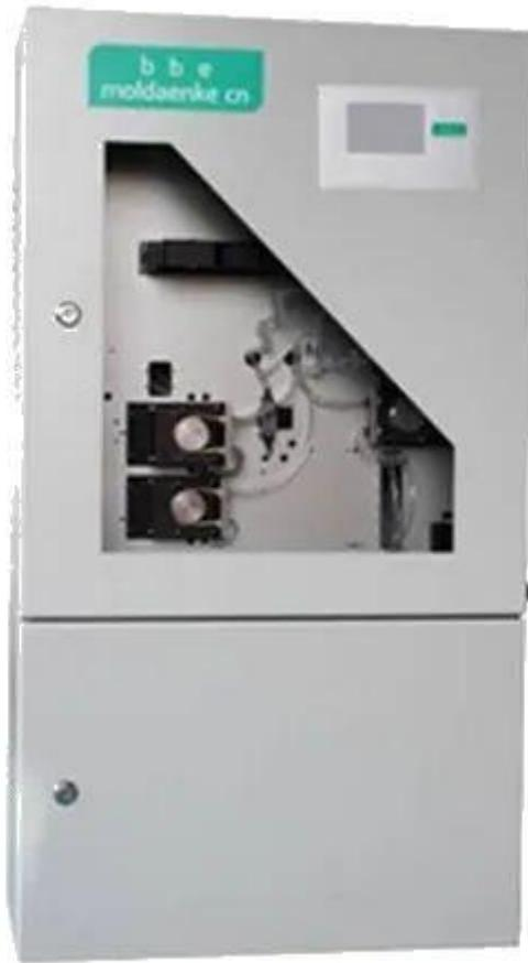
在线氨氮水质分析仪具有以下性能特点：全自动分析，自动清洗，周期任意设定，自动校准，手动校准，极低的检出极限；超高精度蠕动泵实现液体输送，确保超高测量重复性；模块化设计，维护简便，量程可调可扩展；触摸屏显示，操作简单易学；故障报警，出错报警，来电自启动功能；支持 4-20mA，RS232/485 数据传输，MODBUS，TCP/IP 通讯(选配)。
