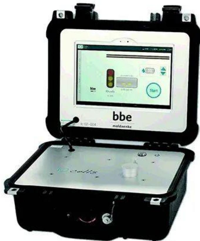
实验室藻毒素预警仪可以测量游离藻蓝蛋白浓度，藻分类，叶绿素 a 及光合作用活性，同时可用于自来水异臭异味物的实验室常规测量。仪器能够快速分析出水中的叶绿素 a 和游离藻蓝蛋白浓度，而游离藻蓝蛋白是水源中蓝藻毒素和异臭异味物的重要的指示物，在线 PhycoSens 同时能够测量藻类的光合作用活性和透光性，黄色物质的测量可以用于修正测量结果。
