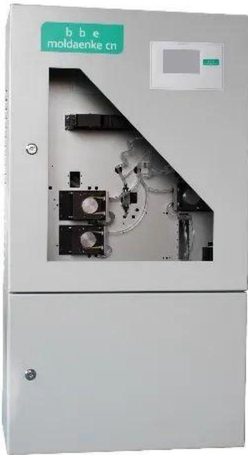
在线挥发酚水质分析仪配备在线蒸馏装置、独有气泡隔断蒸馏技术，确保挥发酚被完全蒸馏；全自动分析，自动清洗，周期任意设定；自动校准，手动校准；较低的检出极限；超高精度蠕动泵实现液体输送，确保超高测量重复性。模块化设计，维护简便，量程可调可扩展；触摸屏显示，操作简单易学；故障报警，出错报警，来电自启动功能；支持 4-20mA, RS232/485 数据传输，MODBUS, TCP/IP 通讯（选配）；配备独特的蒸馏装置。
