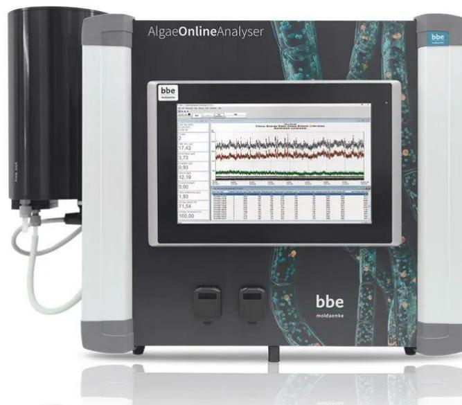
在线藻类分析仪是一款专门对各种藻进行分类以及对各类藻的浓度进行定量检测的实时检测设备,相比传统的培养和显微镜检测法,在线藻类分析仪分析快速、操作简便,减轻了藻类分析的工作量,并有效地减少了人为误差。
