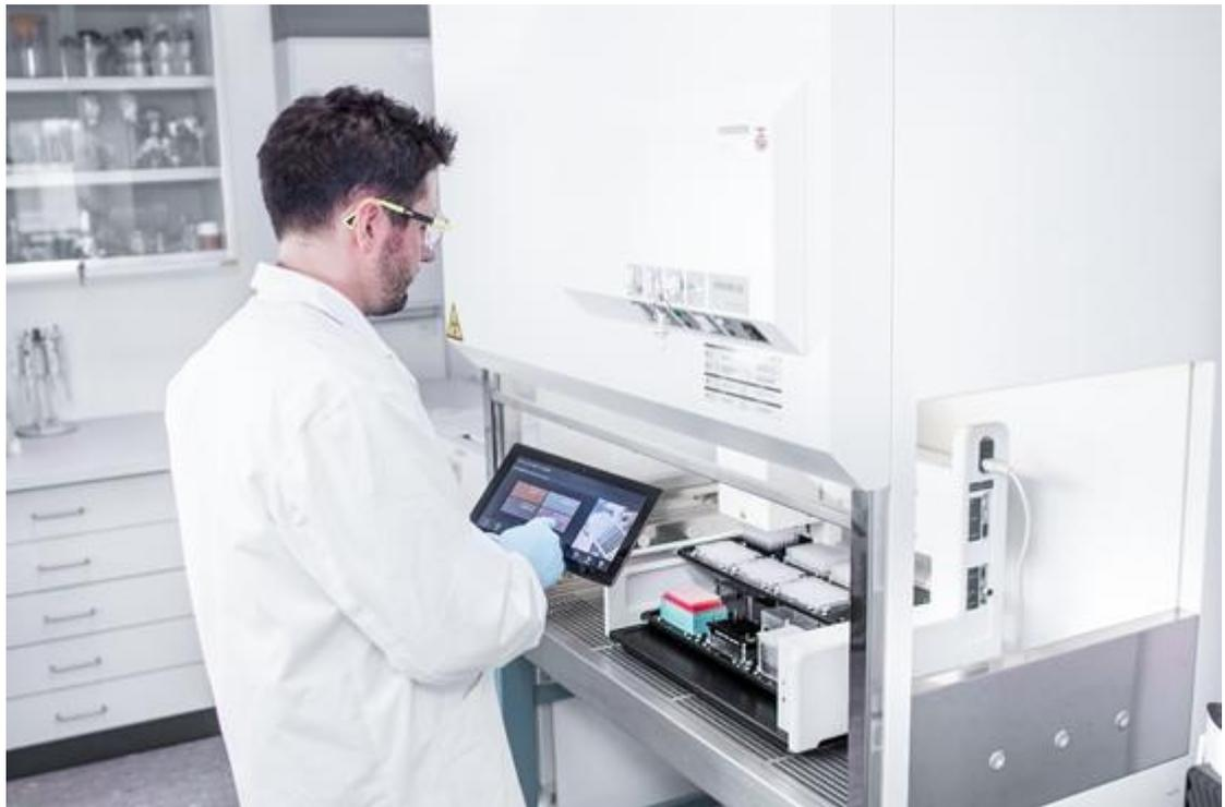
德国耶拿公司 CyBio-Felix 自动移液工作站可置于常规生物安全柜内，自动完成基于细胞表型筛选工作中的液体处理工作。
