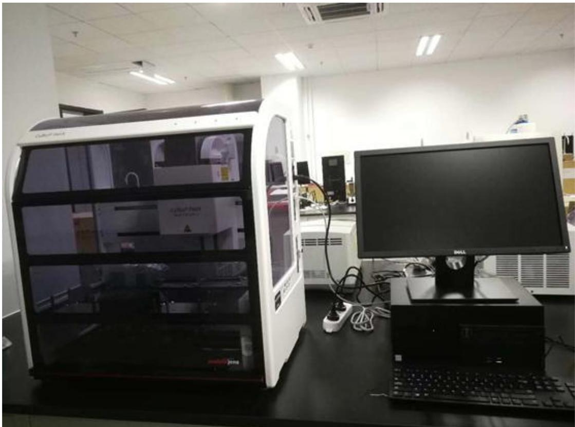
德国耶拿公司 CyBio-Felix 自动移液工作站可以搭载 384 通量的移液头完成高精度、高均一的整板同步移液。也可以在整板同步移液前后，自动切换为单列 16 通道或者单排 24 通道的移液方式，自动完成连续梯度稀释的工作。相比于手工或半自动系统，拥有 12 个标准 SBS 板位的自动移液工作站 CyBio-Felix 不仅可以提高筛选效率和自动化程度，也可更好的提升筛选体系的标准化程度。
