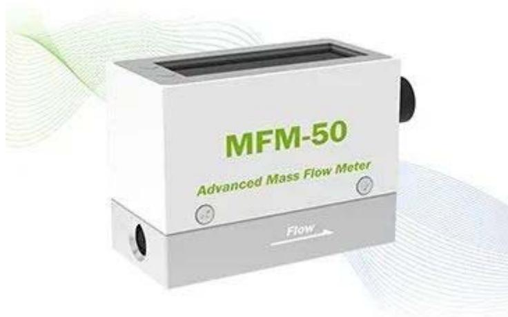
MFM-50 系列气体质量流量计，采用航空级铝合金基座和 Exia IIC T4 Ga 本安型防爆设计，具有精度高（最低 0.5%）、量程比宽（优于 100 :1）、响应速度快（最快 15ms）、温漂小（0.01% F. S. /°C）、性价比高、一体化集成等优点，适用于实验室安全用气改造、氢能、生物制药、钎焊等行业。
