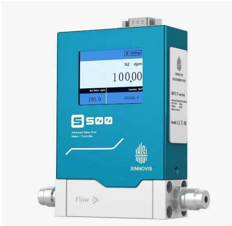
S500 系列气体质量流量控制器，产品独有的标定算法，可实现灵活的分流比配置，量程覆盖 1sccm-120slm，最小控制精度为 0.1sccm，并在 0-50℃温度范围内进行自动化温补。支持客户现场调试或控制，根据实际需要可实现气体种类切换和满量程切换，适用于光伏、真空镀膜、钎焊、环保等多行业应用。
