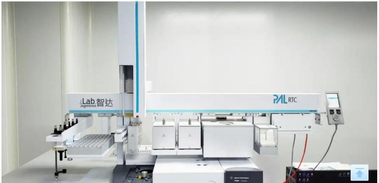
多功能在线样品前处理及自动进样平台，您所能想象的在一台仪器上皆有可能实现，产品的功能包括样品制备、稀释、衍生化、SPE、过滤、SPME、标准添加等。
